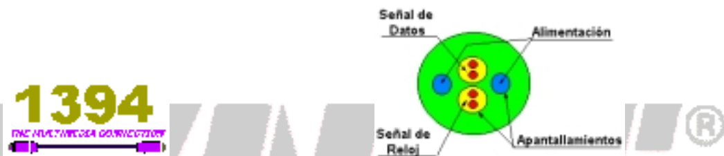
Figura 50. Corte transversal del cable Fire Wire.
